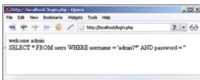
Abbildung 4. Bypass Login durch SQL Injection 2
